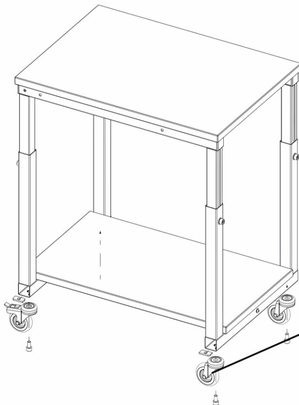
Прикрутить опоры колесные к каркасу ПСМ
