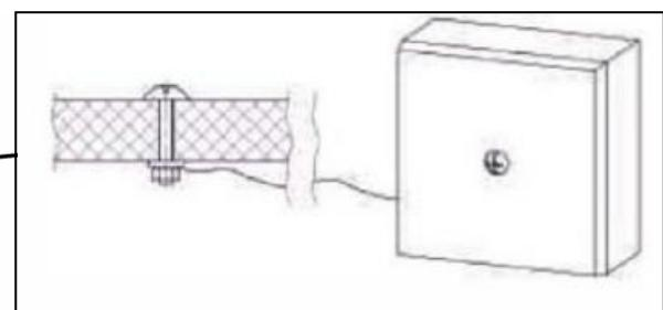
Закрутить винт. Зажать клеммой гайкой. Провести провод от винта до клеммной коробки.
